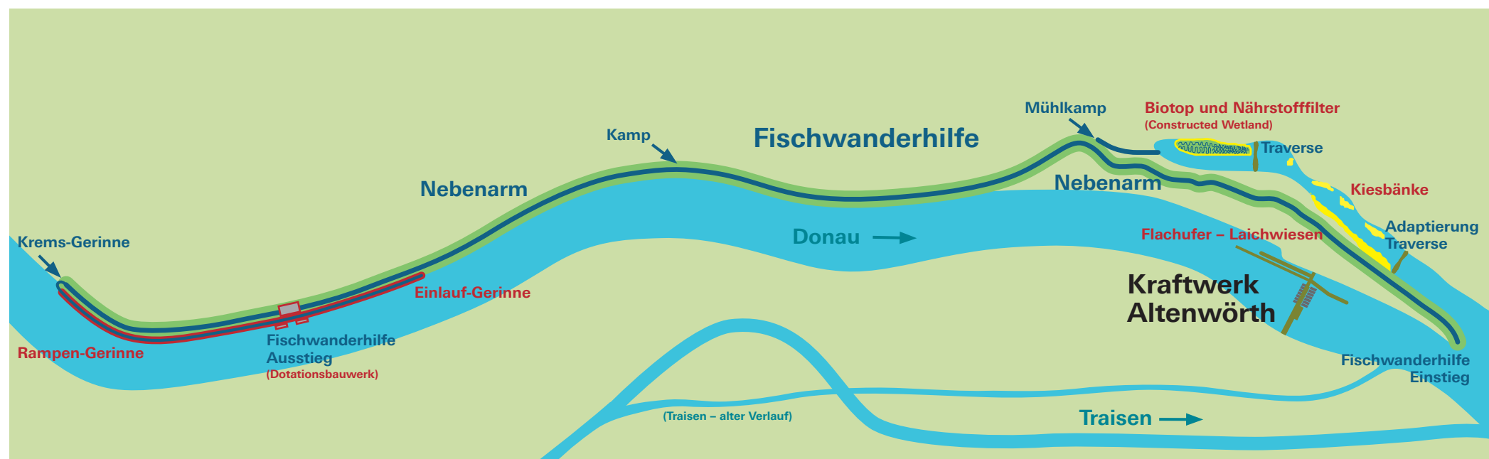
Beispiel für einen naturnahen Umgehungsbach beim Donaukraftwerk Ottensheim-Wilhering
