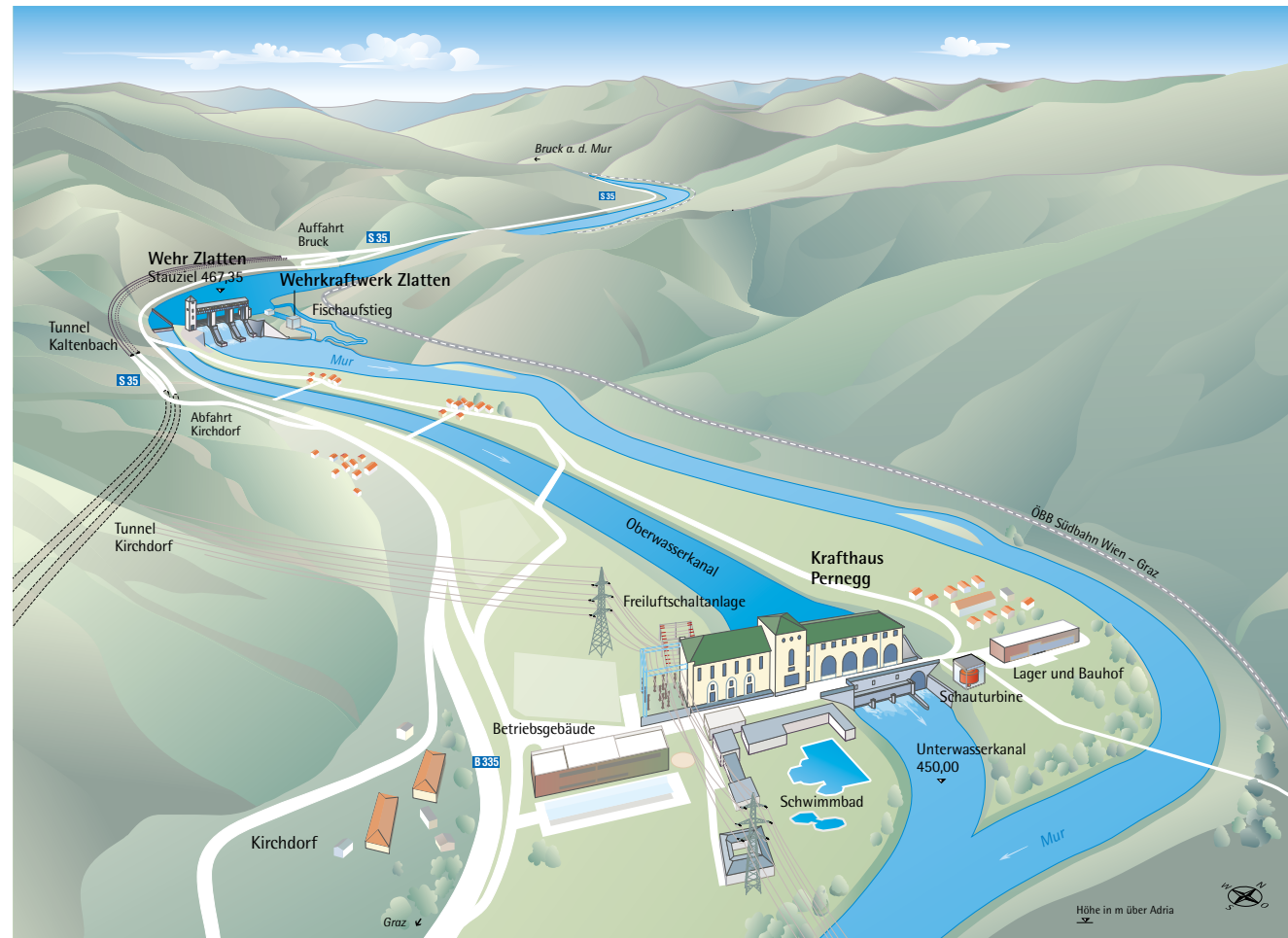
Kraftwerk Pernegg mit Wehr Zlatten, schematische Darstellung
