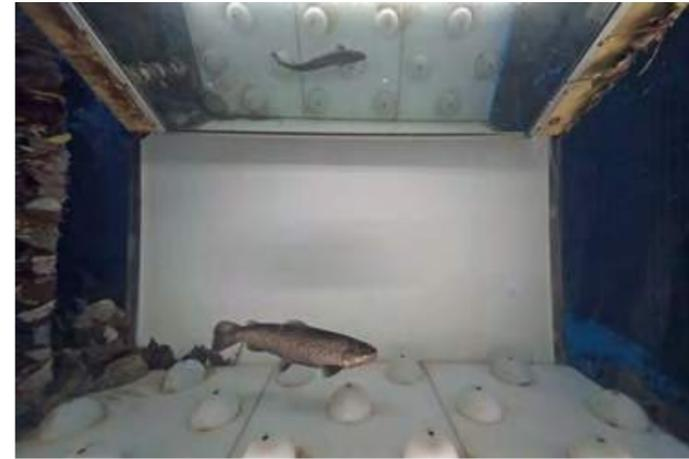
Abb. 3: Über den Spiegel lässt sich der Abstand des Fisches zur Kamera bestimmen. Mit dieser Information, zusammen mit den bekannten Abmessungen der Sohlenelemente im Erfassungstunnel, lässt sich die im Bild erscheinende Größe des Fisches in seine tatsächliche Länge in Zentimeter umrechnen.
