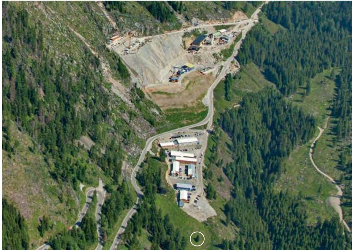
Abb. 10: Temporäre Landschaftseingriffe des Projekts Reißeck II für das Baulager, für Deponiebereiche und für Montagehallen; in Hinblick auf Abb. 11 sei auf die einzeln stehende Fichte in der Bildmitte, unten, verwiesen.
