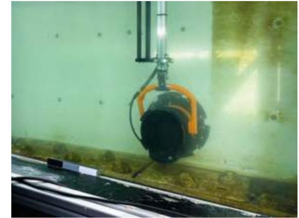
Abb. 8: Der neu entwickelte robotergesteuerte Schrubbreiniger bei der Reinigung der Rückwand der Dauermonitoringanlage.
