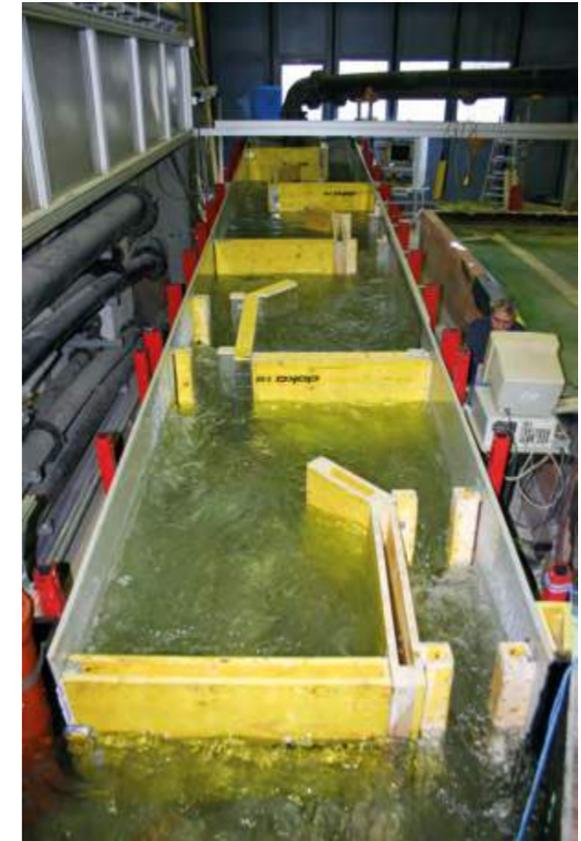
Abb. 1: Entwicklung des *enature*® Fishpass im Wasserbau-labor der BOKU Wien im Maßstab 1:1. Das Modell wurde über 40-mal umgebaut und dadurch optimiert.
