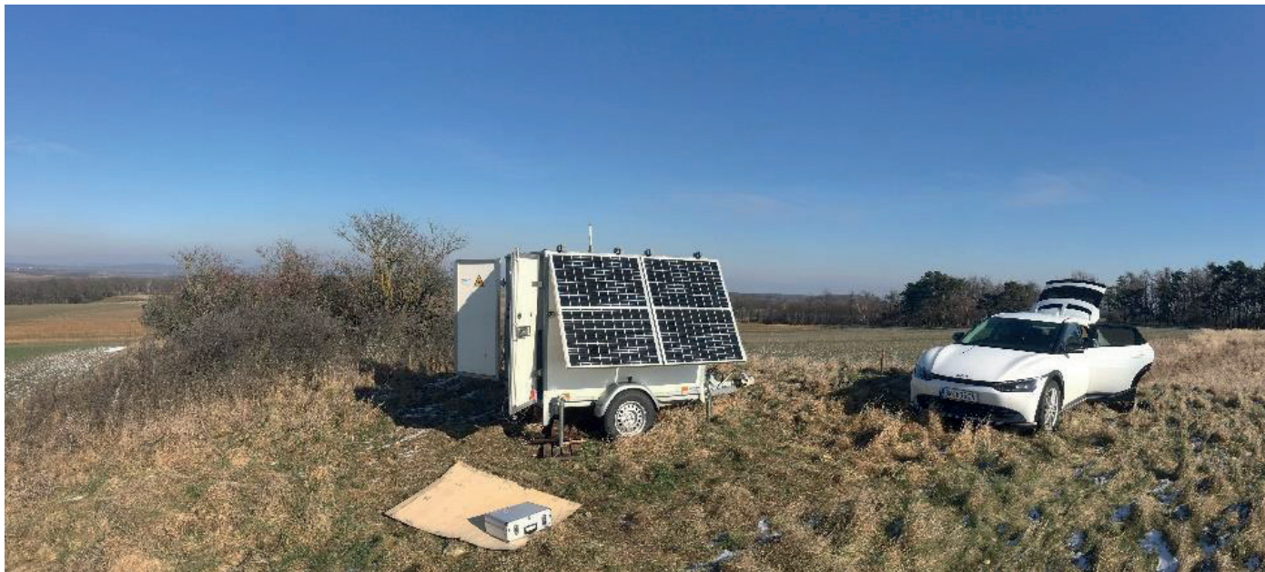
Optimaler Standort des LiDAR-Messgeräts für zuverlässige Winddaten
